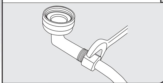
Raccorder le raccord de compression de  $\frac{3}{8}$ " à la canalisation d'alimentation en eau avant d'installer l'appareil dans l'ouverture découpée dans le placard. Le fixer de façon à ce que le raccord de  $\frac{3}{4}$ " soit orienté vers le haut.
